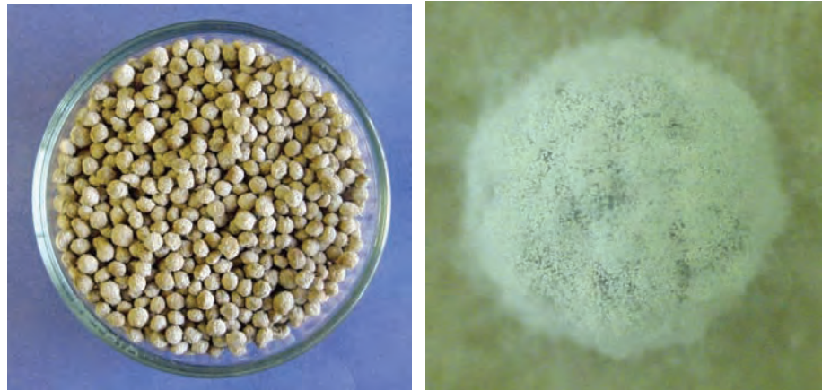
Foto 3. Formulado de pellets de alginato, inoculados con HEP (Foto gentileza de Irina Urtubia).
